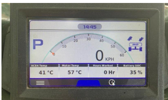
► Dashboard end of route (14:45): ACE4 41°C, Motor 57°C, SOC 35 %
