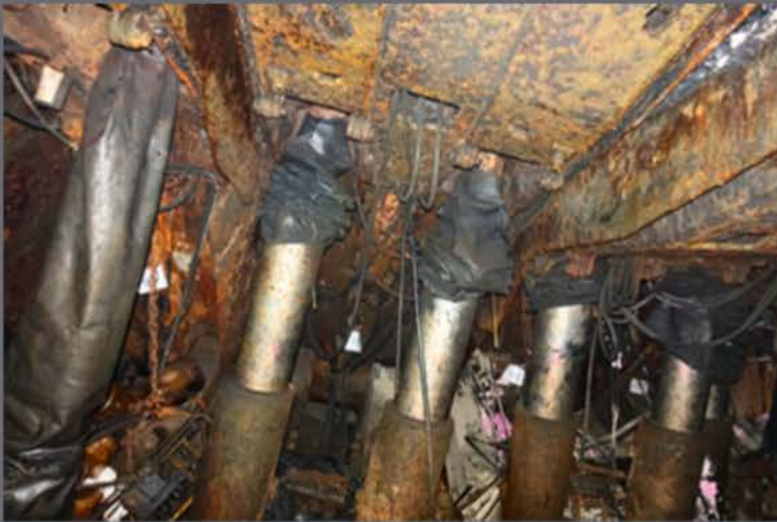
Ściana (1) - skutki odchylenia od prostoliniowości 3,13m Opad skał stropowych od sekcji 80 do 104 sekcji
