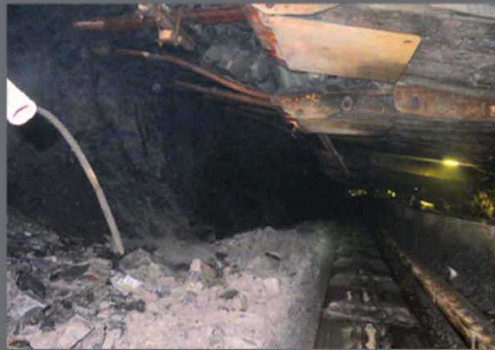
Ściana (2) - skutki odchylenia od prostoliniowości 3,35m
