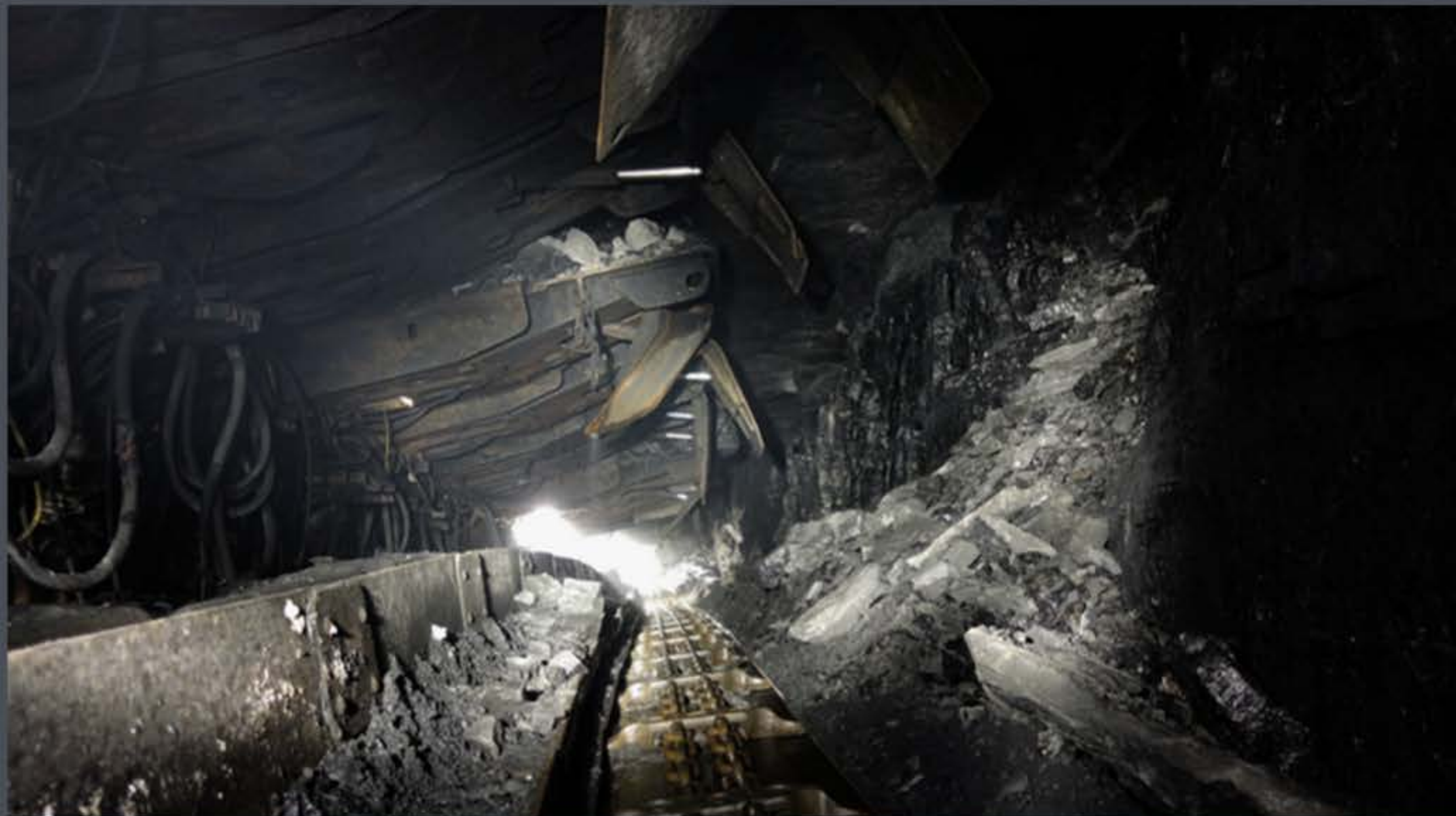
Ściana (3) - skutki odchylenia od prostoliniowości 3,37m
