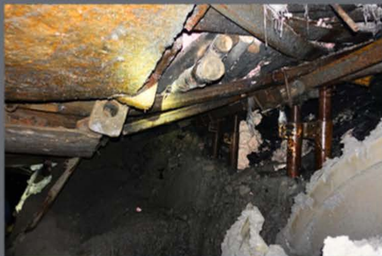
Ściana (1) - skutki odchylenia od prostoliniowości 3,13m Opad skał stropowych od sekcji 80 do 104 sekcji
