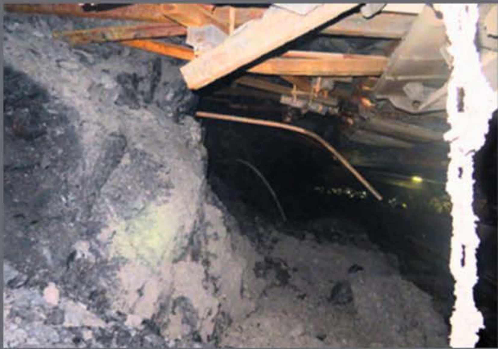
Ściana (2) - skutki odchylenia od prostoliniowości 3,35m
