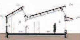
Orientation Sud, construction bois pour des logements basse consommation à Marigny (50)
