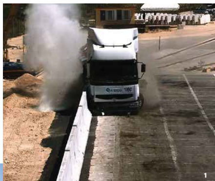
1, 2. L'innovativa barriera in calcestruzzo Abesca H120 W2 prodotta da Cancellotti dal campo prova alla strada
