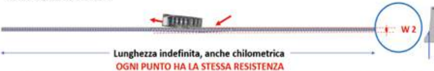
12. Comportamenti del New Jersey H120-W2 frenato
