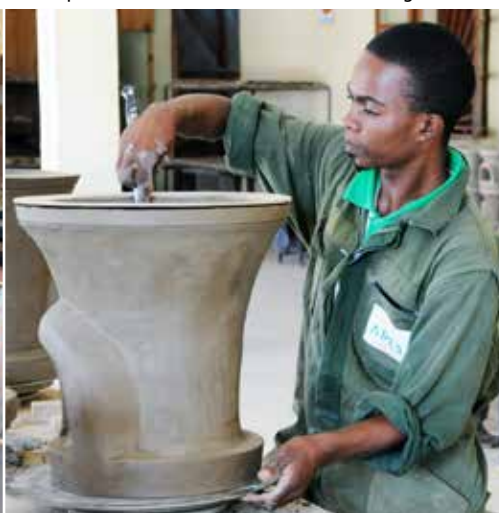
Benjamin, producteur malgache de fourneaux, fabrique une chambre de combustion en argile.
