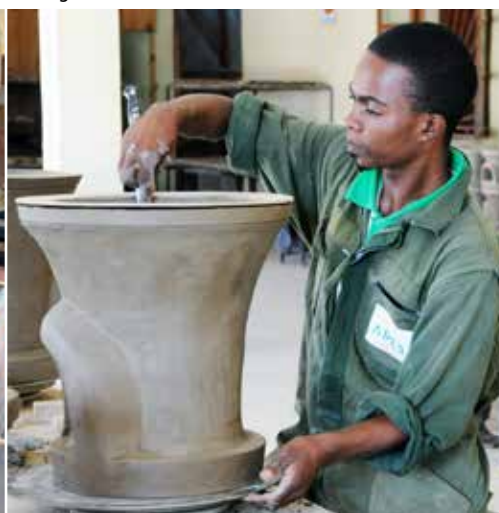
Der madagassische Kochherd-Bauer Benyamin fertigt eine Tonne-Brennkammer aus Lehm
