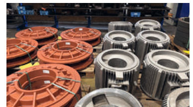
Klassische Barth-Produkte sind hochpräzise Metallteile wie Gehäuse, Ringe, Flansche, Wellen und Deckel
