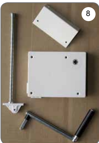
Kurbelwickler für Schnur, Winkelplatte für Kurbel- wicklermontage, Schnurführung, Handkurbel [8].
