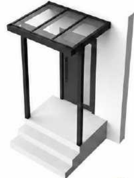
Eingangsüberdachung mit Überstand
