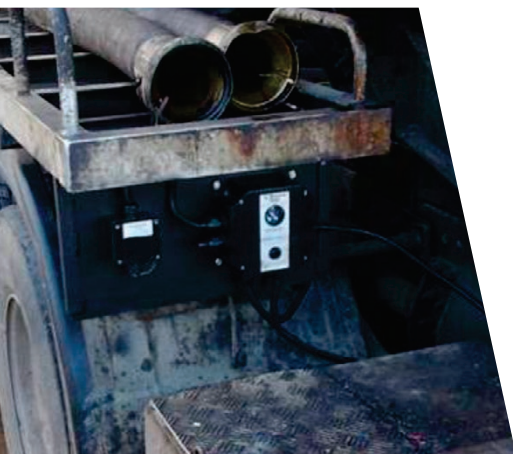
Il sistema di messa a terra Earth-Rite II MG può essere montato sugli autospurghi e le autocisterne
