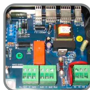
PCB DI ALIMENTAZIONE CC
