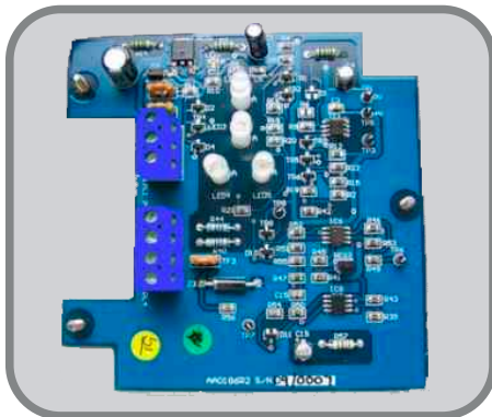
PCB DI MONITORAGGIO
