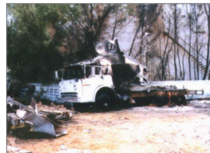
Fig. 2 – Dall'alto al basso, Veicolo 1, 2 e 3. Il National Safety Transportation Board (NTSB) ha concluso che il danneggiamento e l'incendio degli altri due veicoli era dovuto all'esposizione al calore generato dall'incendio del Veicolo 1. I veicoli contenevano in totale circa 9.200 galloni di combustibile, i quali avrebbero alimentato il rogo.
