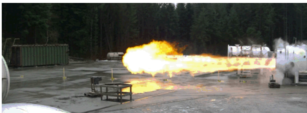
Fig. 3 - Una esplosione di polvere in uno spazio confinato e dotato di sfiati, per gentile concessione di IEP Technologies
