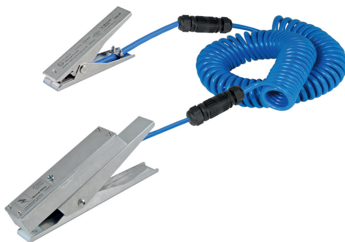
Bond-Rite® EZ con indicatore a LED montato nella pinza che lampeggia in verde quando una resistenza di collegamento di 10 ohm, o inferiore, viene stabilita tra attrezzature portatili conduttive.
