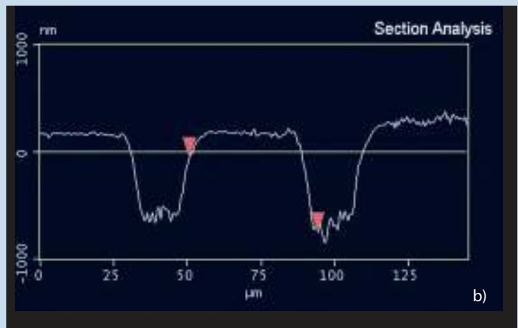
Profilanalyse (a und b) der laserstrukturierten Metalloberfläche (AFM)
