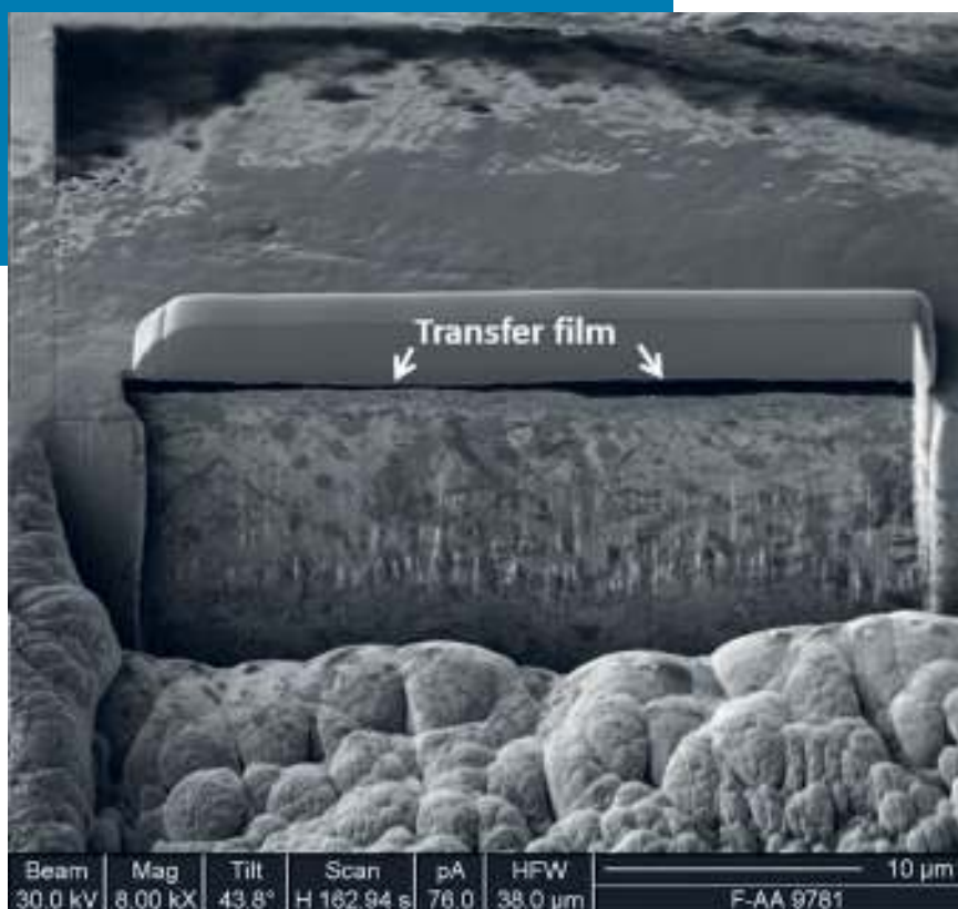
Identifikation des Transferfilm nach einem FIB-Ausschnitt (REM)
