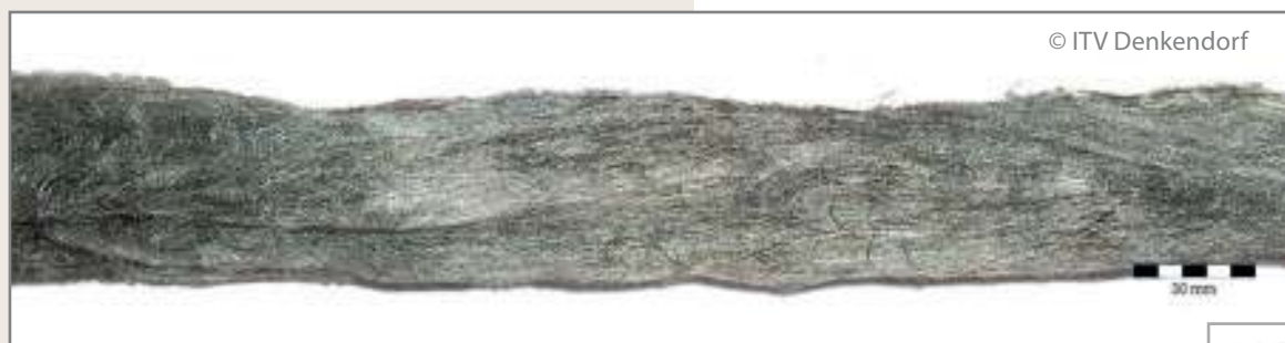
Stapelfaser-Band aus recycelten C-Fasern
