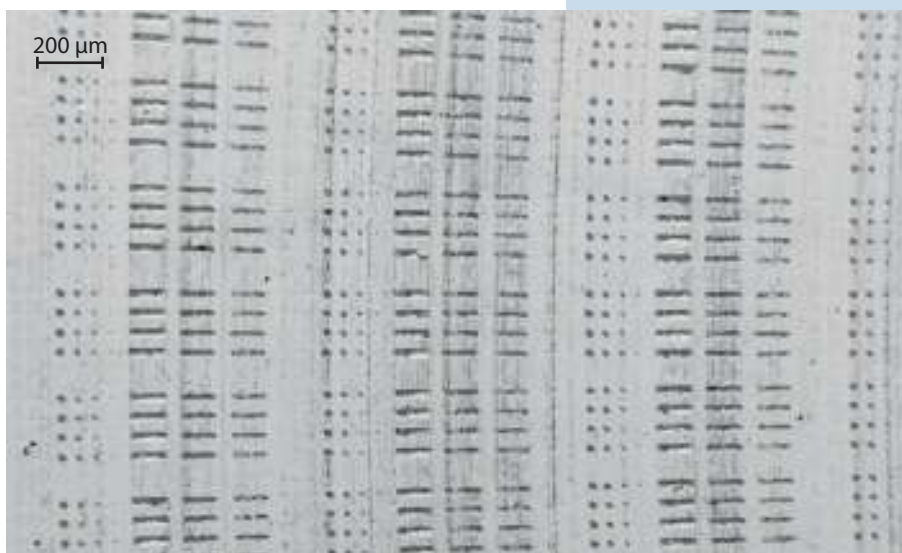
Laserstrukturierte Stahloberfläche nach tribiologischer Prüfung (REM)
