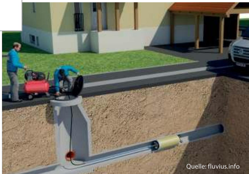
Schematische Darstellung der grabenlosen, partiellen Rohrsanierung mit imprägnierten Glasfasergewebematten und aufblasbarem Kurzliner-Packer
