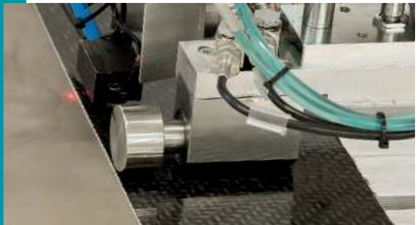
Voll automatisierbarer Schweißkopf zum Induktionsschweißen
