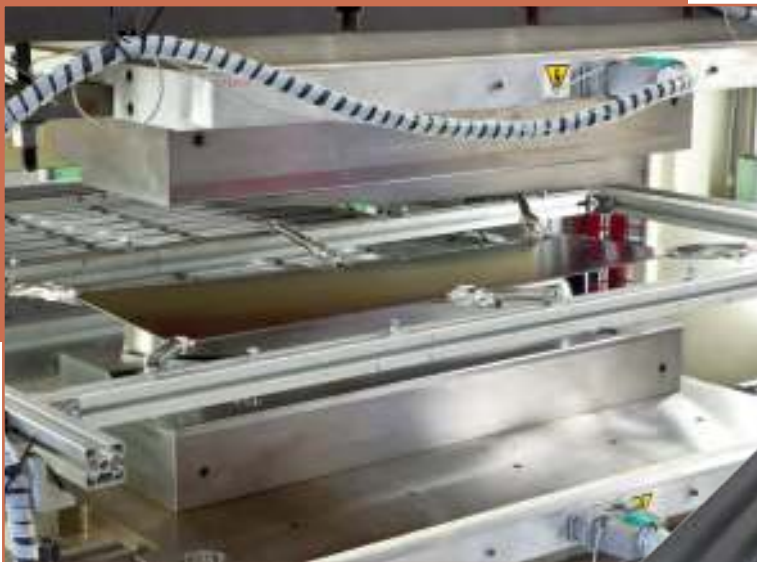
Organoblech im Spannrahmen
