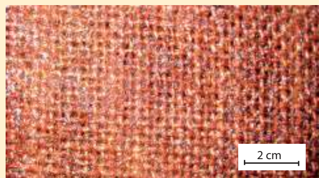
Prepreg: mit Furanharz vorimprägniertes Naturfasertextil
