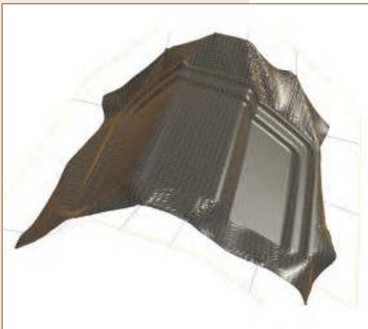
Umformsimulation am Organoblech eines Karosseriebauteils
