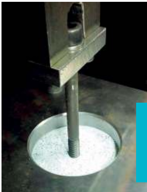
Testaufbau für die Messung der Zugfestigkeit der Schraubverbindung
