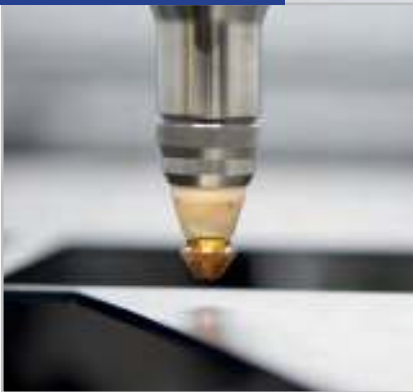
Schneidkopf mit Düse Cutting head with nozzle
