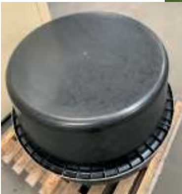
Auffangbecken aus bio-basiertem SMC
