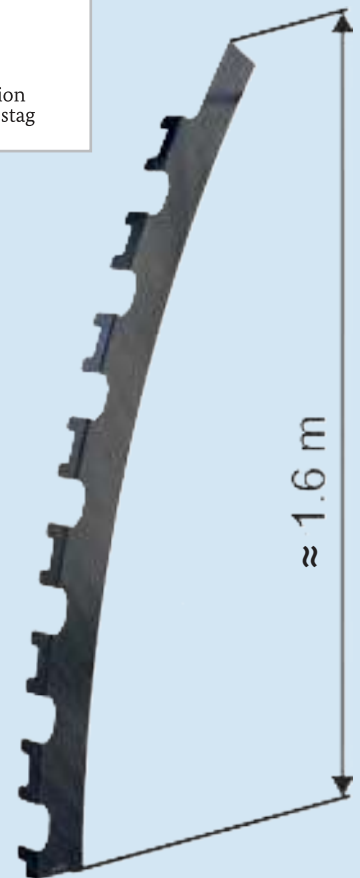
Small-Scale Demonstrator eines Rumpfschalen-Integralspantes
