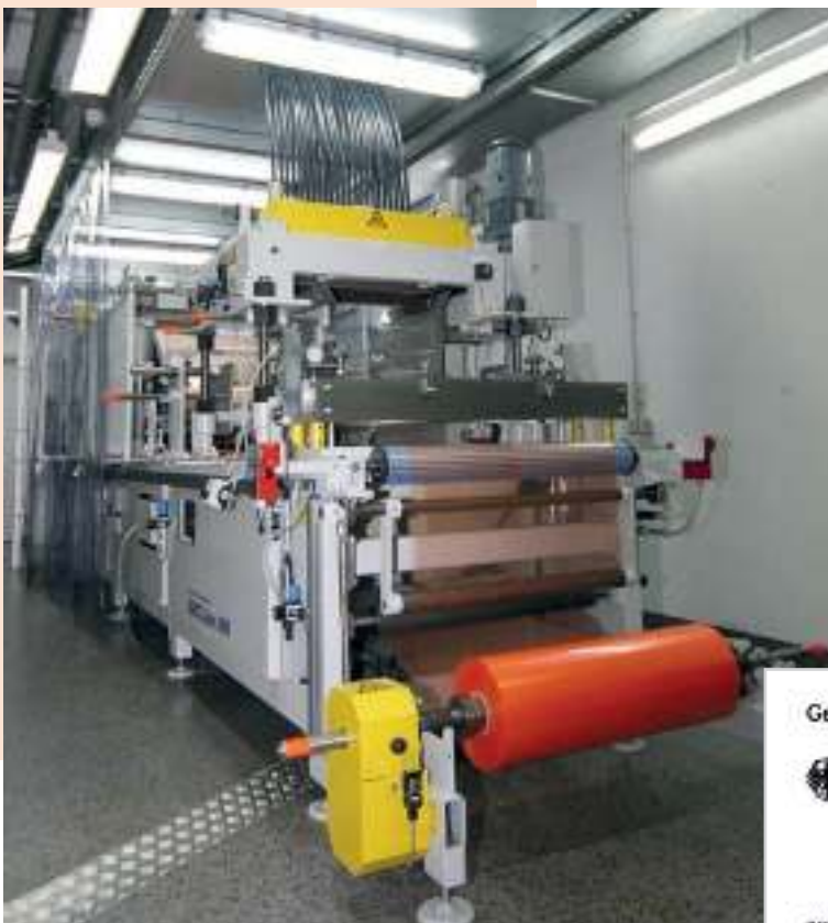
Institutseigene SMC-Anlage mit 600 mm Arbeitsbreite
