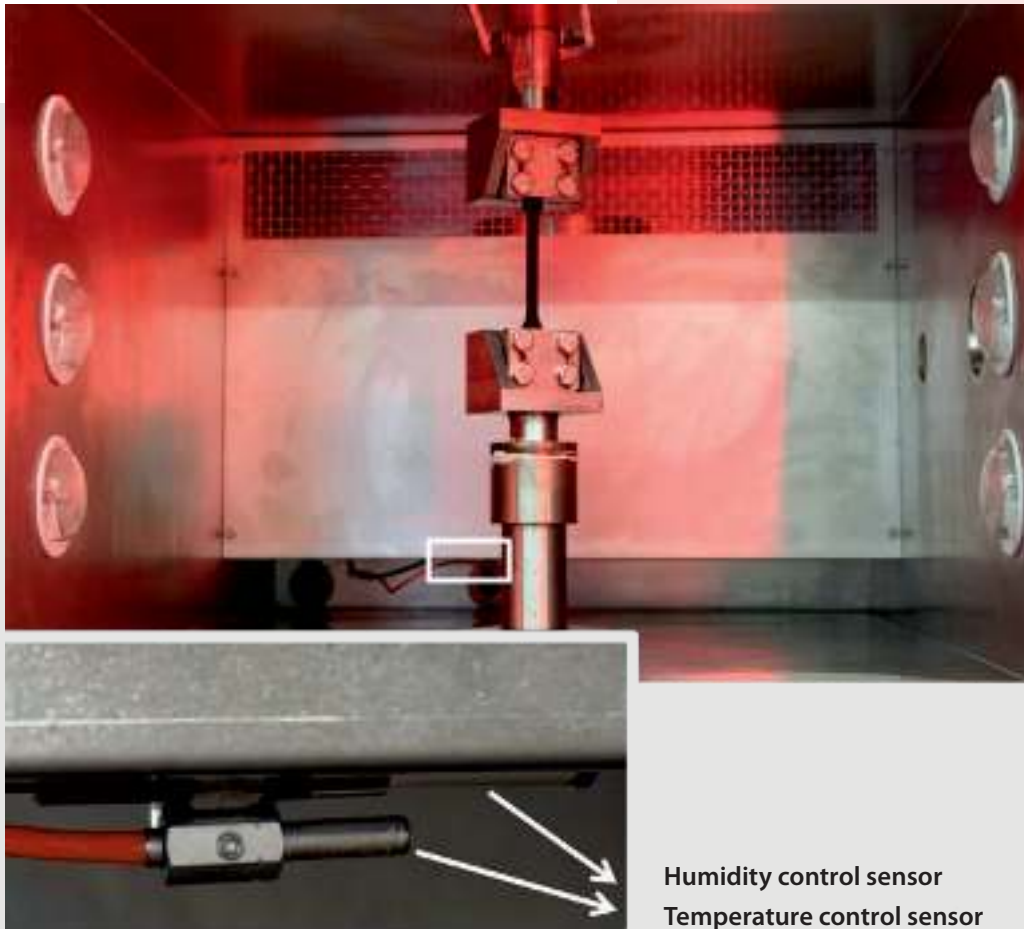
Versuchsaufbau für quasistatische Zugversuche in der Klimakammer
