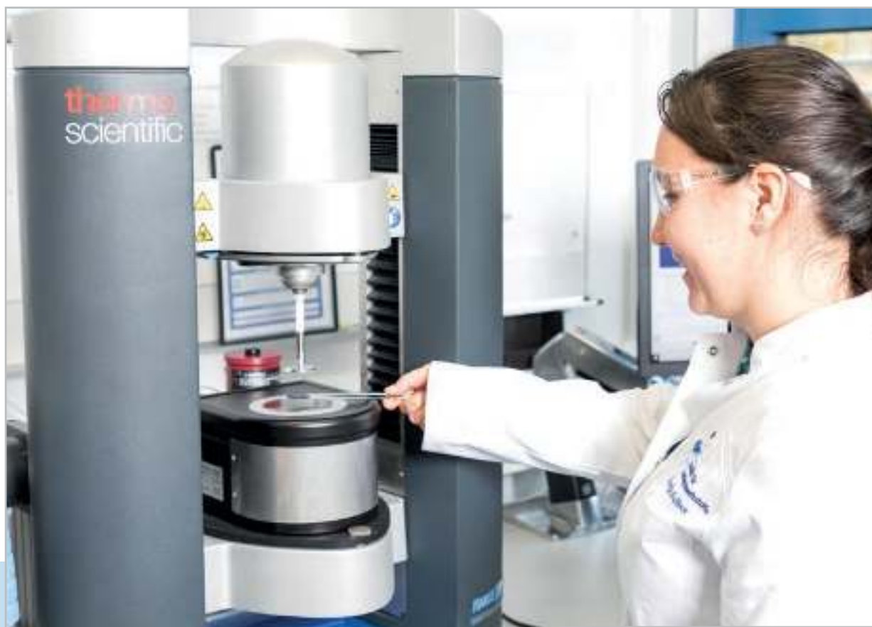
Einsetzen einer Probe am Plattenrheometer
