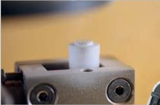
Abbildung des Stift-Scheibe-Versuchs
